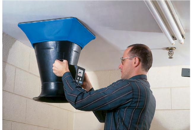
LoFlo Balometer® Capture Hood主要用于住宅或轻型商业应用, 测量范围为10至500 cfm ( 17至850m<sup>3</sup>/h )。紧凑的尺寸使得它们可以在不适合全尺寸抽油烟机的地方使用, 例如在浴室隔断或文件柜上。
