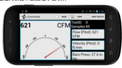
利用无线蓝牙®技术,此应用程序适用于基于Android™的智能手机和平板电脑,可与仪器进行远程通信,距离相距100英尺(30.5 m)远,并实时显示样品数据。附加评论,语音注释和照片以测试ID数据,以通过电子邮件导出以生成报告。
