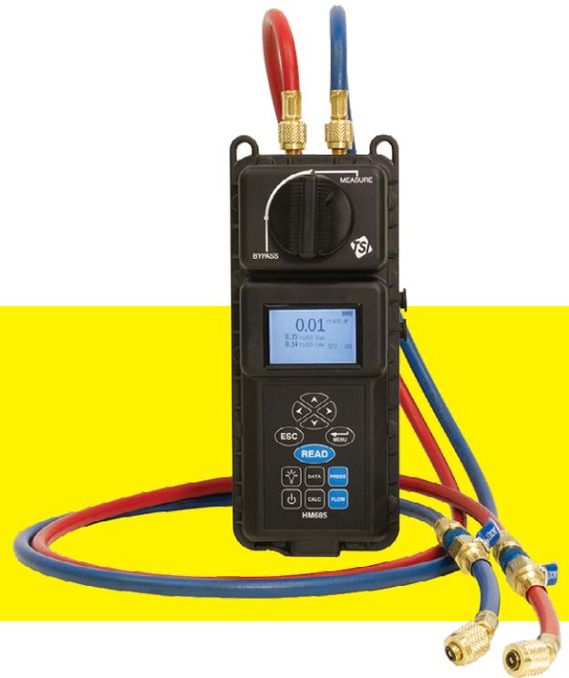
HM675和HM685平衡阀流量测试仪用于平衡水力加热和冷却系统，检查泵的性能并设置平衡阀。他们可以同时测量和显示差压，高压侧和低压侧压力，而无需更改软管连接或仪表阀设置。每个型号均配有背光显示屏，并使用四节碱性或NIMH可充电电池供电。
