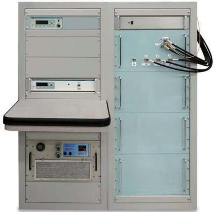
图 1- 1314 型量热计(包含循环制冷器)、以及滤波器和开关组 (滤波器和开关组用于校准鸟牌功率计, 目的是消除放大器谐波)
