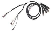
3514—BNC转平接线片 适用于3525和3550型LCR表, 0.9m长。
