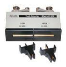
3510—放射型引脚转接夹具 适用于带引脚的器件,例如放射性引 脚器件的四线法测试。夹具可以方便 地允许器件引脚的插入和拔出,夹片 电极的力度和距离都可以调整。适 用于3525和3550型LCR表。
