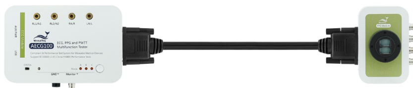
图 4：主机透过 DB15 线材相接
